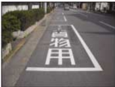
既設パーキング・チケット駐車枠の1枠を貨物車優先に変更
