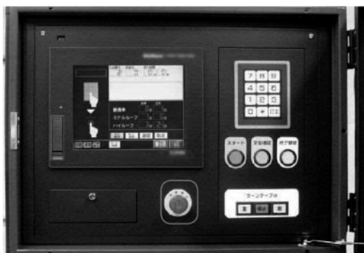
緊急停止ボタンの設置例
